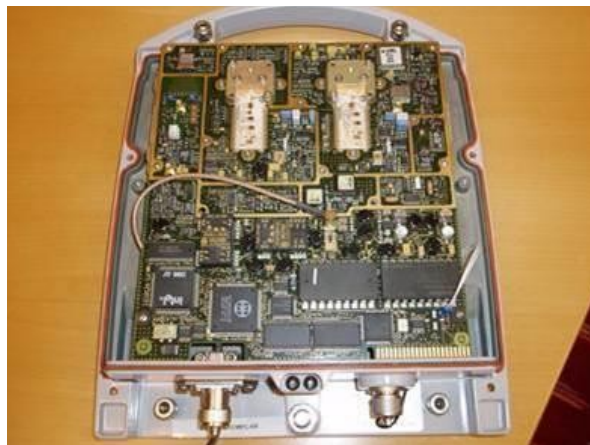
RAU2: Radiokort med Tx- & Rx-MCM:er monterade på ett FR4 flerlagers kort
