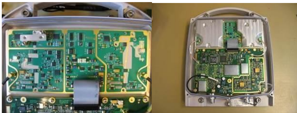
RAU2-1, 23 GHz: Mikrovågskort med kapslade komponenter (Vänster), Radio med monterade Mikrovågskort & kontrollkort (Höger)
