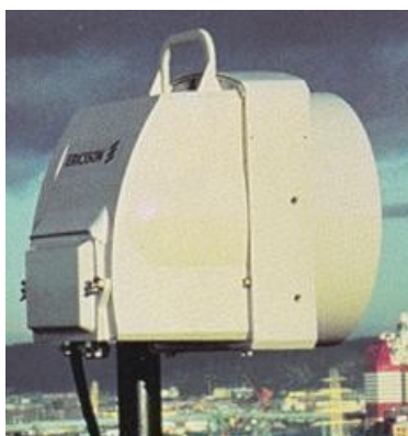
Utomhusdel MINI-LINK C (radio + antenn)
