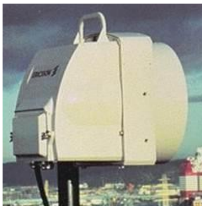
Utomhusdel MINI-LINK C (radio inkl modem + antenn)
